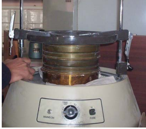
Resim 4: Elek sarsma makinesi
