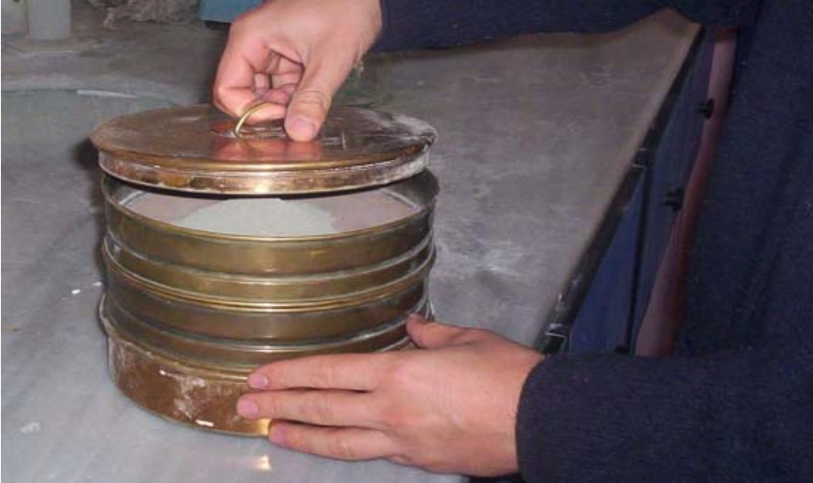
Resim 12: Elek serisinin hazırlanışı ve numunenin konulup kapağının kapatılması
