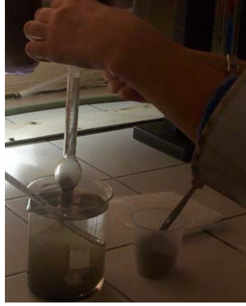
Resim 12: Balonun kenarlarına yapışan çimento tozlarının dökülmesi
