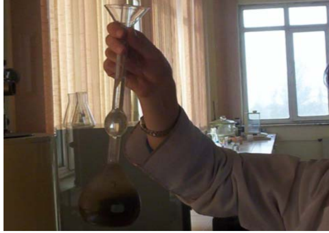
Resim 13: Çimento tozları ile karışan havanın dışarıya çıkarılması
