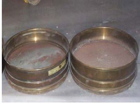
Resim 1: Elekler ( 90 ve 200 mikronluk)
