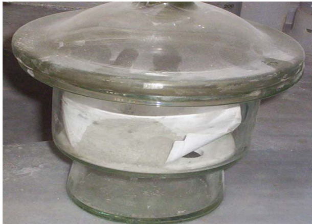
Resim 7: Numunenin soğuması için desikatör cihazı içinde bekletilmesi
