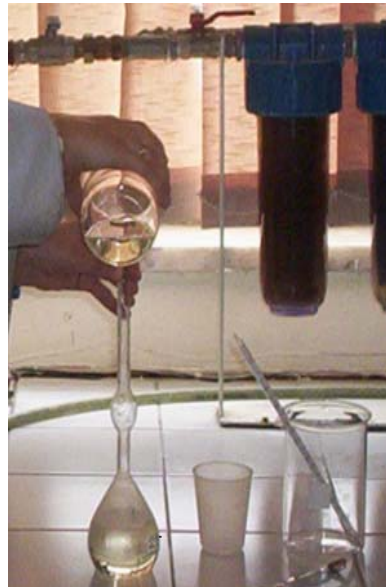
Resim 9: Le Chatelier şişesi içine terebentin doldurulması
