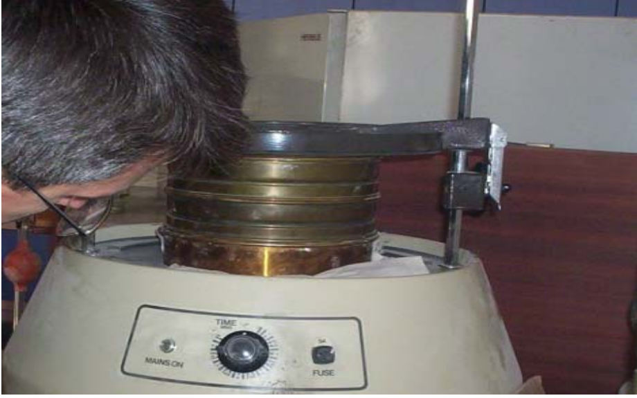
Resim 13: Elek sarsma makinesi ile numunenin elenmesi
