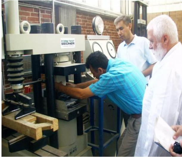
Küp numunesinin kırılmak üzere prese konması
