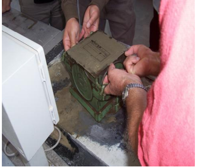
Basınc deneyi için küp numunelerinin alınması
