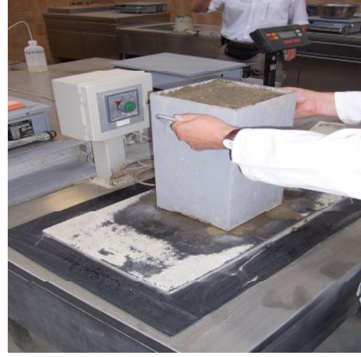
Numunenin masa üstü vibratörle sıkı tırılması
