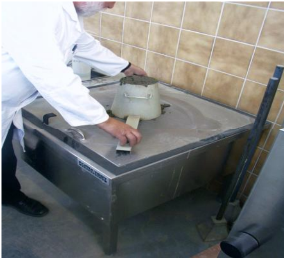
Kıvam deneyi, Slump hunisi metodu
