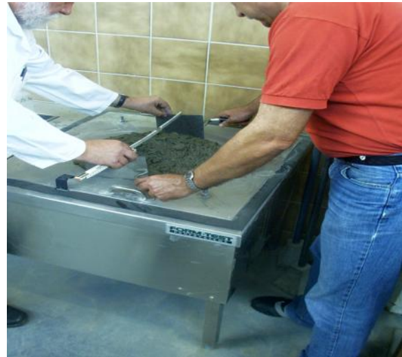
Betonun yayılma mesafesini ölçülmesi
