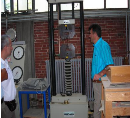
Beton Çeli i çekme deneyi
