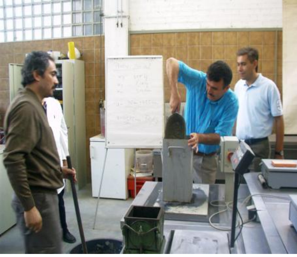
Beton Kıvam tayini, sıkı tırma derecesi metoduna göre
